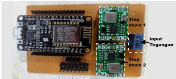
Gambar 6. Rangkaian *power supply*
